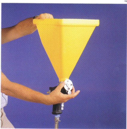
Durch Drehen an der Düsenscheibe wechseln Sie blitzschnell die Spritzöffnung
