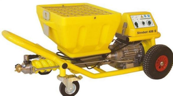
Die Strobot 406 S ist die stärkste Förderpumpe der Strobot-Serie. Sie eignet sich für Fördermengen bis 15 l/ min. Das Kraftpaket ist aber kompakt, handlich und einfach zu bedienen. Die Motorregelung erfolgt drehzahl- oder druckgesteuert und sorgt für eine konstante Fördermenge und damit für ein gleichmäßiges Spritzbild.
