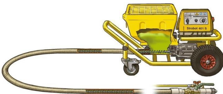
Die Strobot 401 S ist eine spezielle Variante, die statt mit einer Schneckenpumpe mit einem im Förderschlauch integrierten Spiralförderer ausgestattet ist. Durch ihre ganz spezielle Geometrie eignet sie sich hervorragend für die speziellen Anforderungen einiger Akustikputze (wie z. B. von Baswa, Caparol, Sto. etc.).
