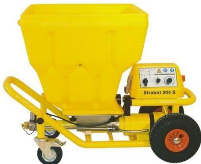
Die Strobot 204 S ist die kleinste Förderpumpe der Strobot-Serie. Sie eignet sich für Fördermengen bis 5 l/ min. Sie ist sehr kompakt, handlich und einfach zu bedienen. Die Motorregelung erfolgt drehzahl- oder druckgesteuert und sorgt für eine konstante Fördermenge und damit für ein gleichmäßiges Spritzbild.
